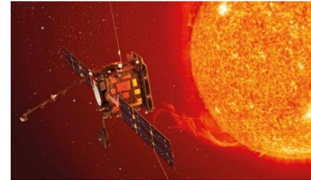
الشكل 8: مسبار Solar Orbiter سيتخذ مداراً مائلاً 25° عن خط استواء الشمس بعد عبورات متكررة قرب الزهرة لرصد قطبي الشمس.
