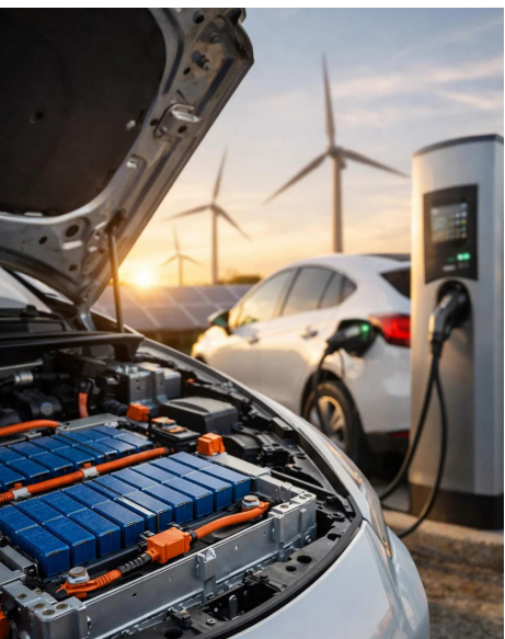
الشكل 4: أصبحت بطاريات LFP الخيار المفضل لعدد كبير من السيارات الكهربائية بفضل أمانها وعمرها التشغيلي الطويل.
